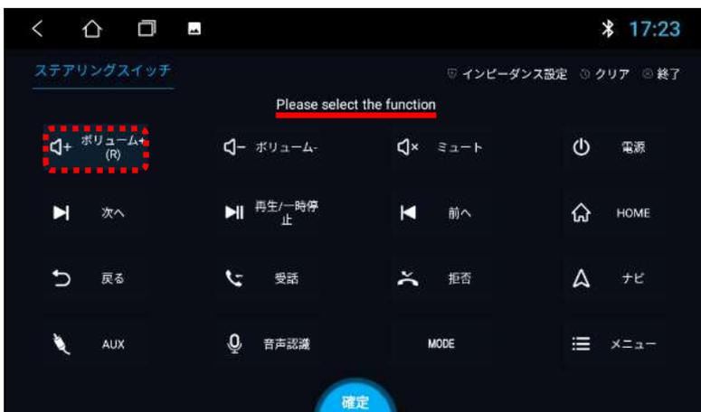
③ステアリングのスイッチ(車両側)を押下
