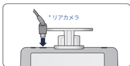
本機と後方カメラを専用ケーブルで接続します。
