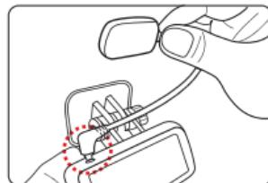
本機(GPS端子)にGPSアンテナを接続します。
