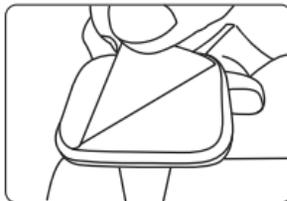
ブラケットに付いている両面テープの剥離紙を取りガラス面に取り付けます。
