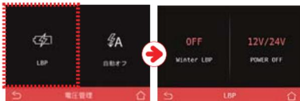
※ LBP機能により電源遮断後、エンジン再始動時に連動して本体を起動させるため、微量な暗電流が流れます。
