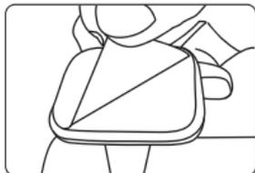
ブラケットに付いている両面テープの剥離紙を取りガラス面に取り付けます。
